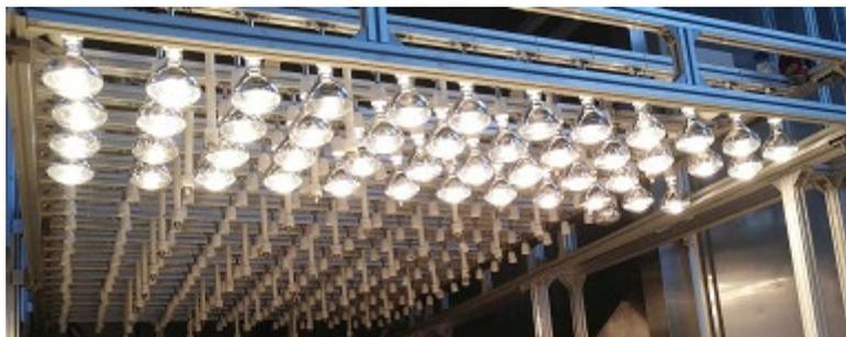
系统安装在试验段顶部，光源的设计考虑了散热，阳光模拟系统带来的热量主要在舱内气流区。
